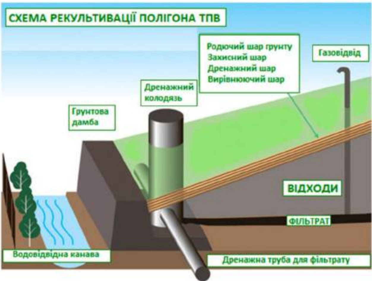
Рисунок 6 - Схема облаштування полігону під час рекультивації
